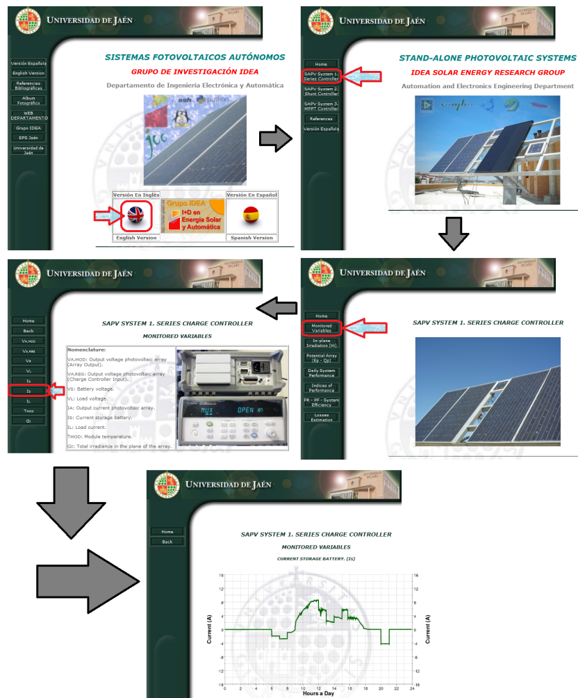
Figura 3: Web para la Monitorización de SFAs. Evolución Diaria de las Variables Monitorizadas. Intensidad de Corriente en la Batería SFA #1.
